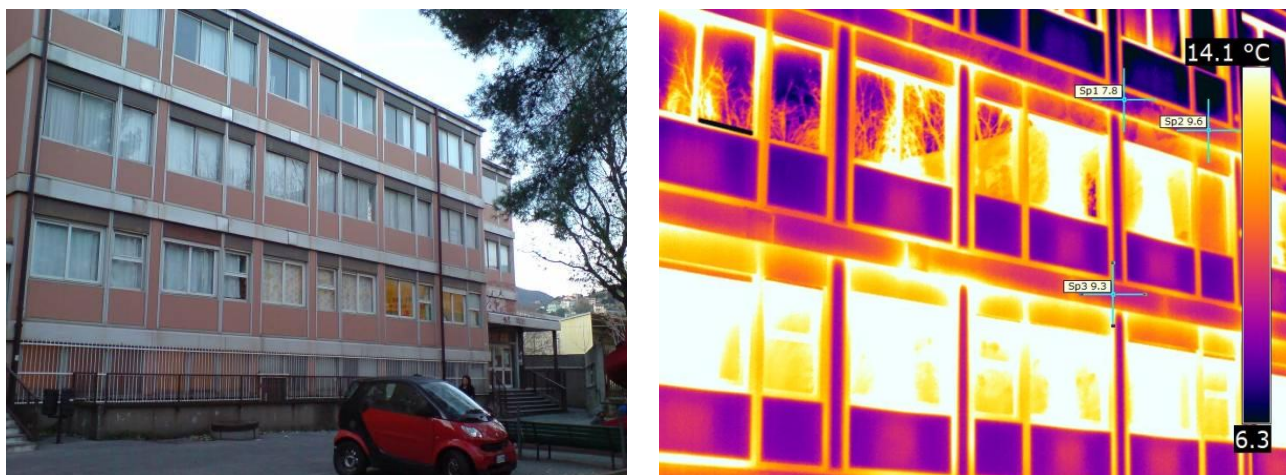
Figura 4.5 – Rilievo termografico dei serramenti del fronte est (lato scuola media e materna)
